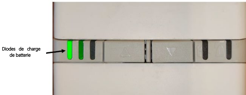
Figure 13 - point DEL - emplacements sur le boîtier de commande
