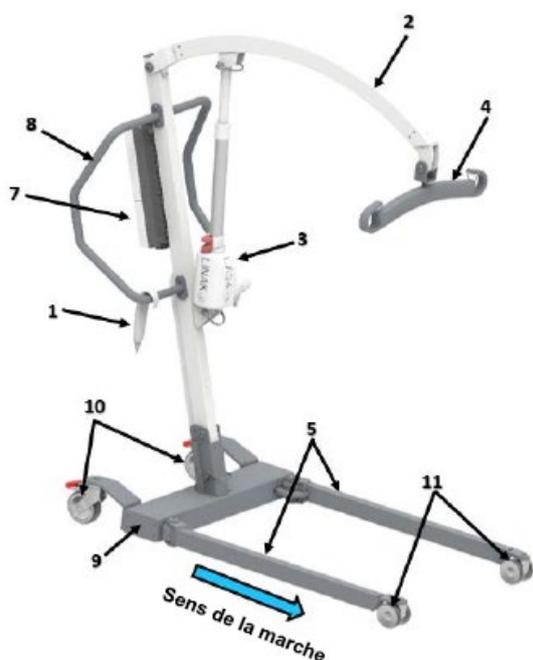
Figure 2a — Éléments structurels du lève-personne Lifteo ELA avec réglage électrique des jambes
