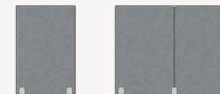
Pour installer une cloison acoustique 2 pieds sont nécessaires. Pour installer 2 cloisons côte à côte, 3 pieds suffisent. Pour tout autre rajout de cloison, rajouter à chaque cloison 1 pied.
