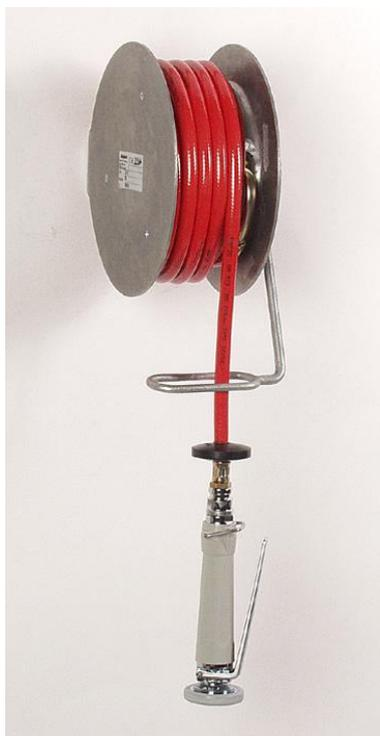
L'enrouleur de tuyau se compose d'un tambour en fonte d'aluminium avec support de sortie pivotant galvanisé et pied en aluminium. Le tube de pression flexible en PVC de 6 m de long avec butée de rebond est conçu pour un maximum de 20 bars / 20°C. Conception avec raccord 3/8 po incluant une transition adaptée pour verrouiller la douchette à main.
