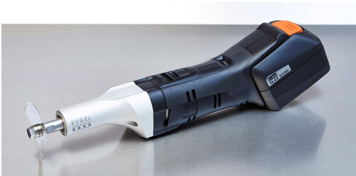
La scie d'autopsie oscillante sera livrée avec une batterie et des lames de scie interchangeables. La scie n'a pas de câble d'alimentation, ce qui la rend idéale pour une utilisation mobile. La tête de scie peut être enlevée et stérilisée. Moteur puissant de 250 watts. un régulateur de vitesse permet un réglage précis afin que l'oscillation de la lame de scie puisse être ajustée avec précision pour répondre aux exigences respectives.
